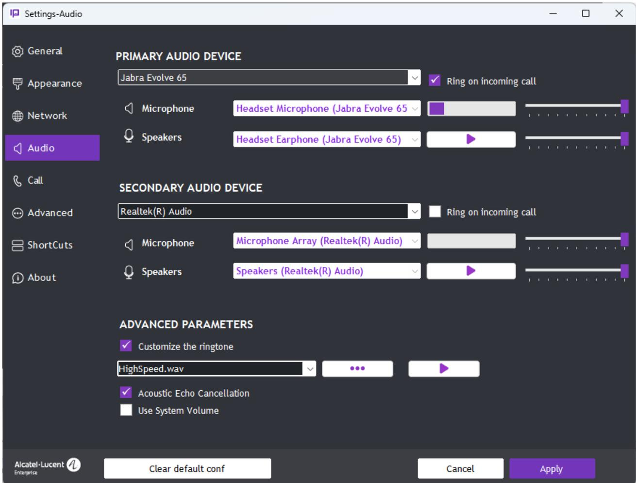
Wenn Sie die zuvor festgelegte Standardkonfiguration entfernen möchten, klicken Sie auf „Standardkonf. löschen“.
