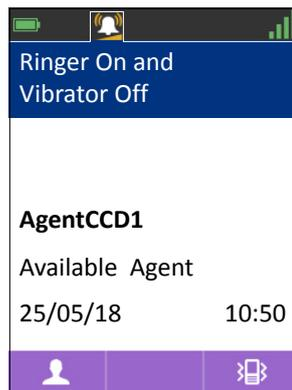
Abbildung 8.1: Beispiel eines DECT-Handapparats im **Ruhezustand**
